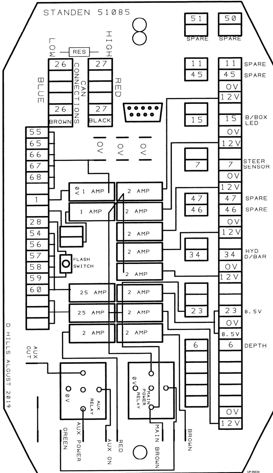
CAN-bus Verteilerkasten (ab 2021)
